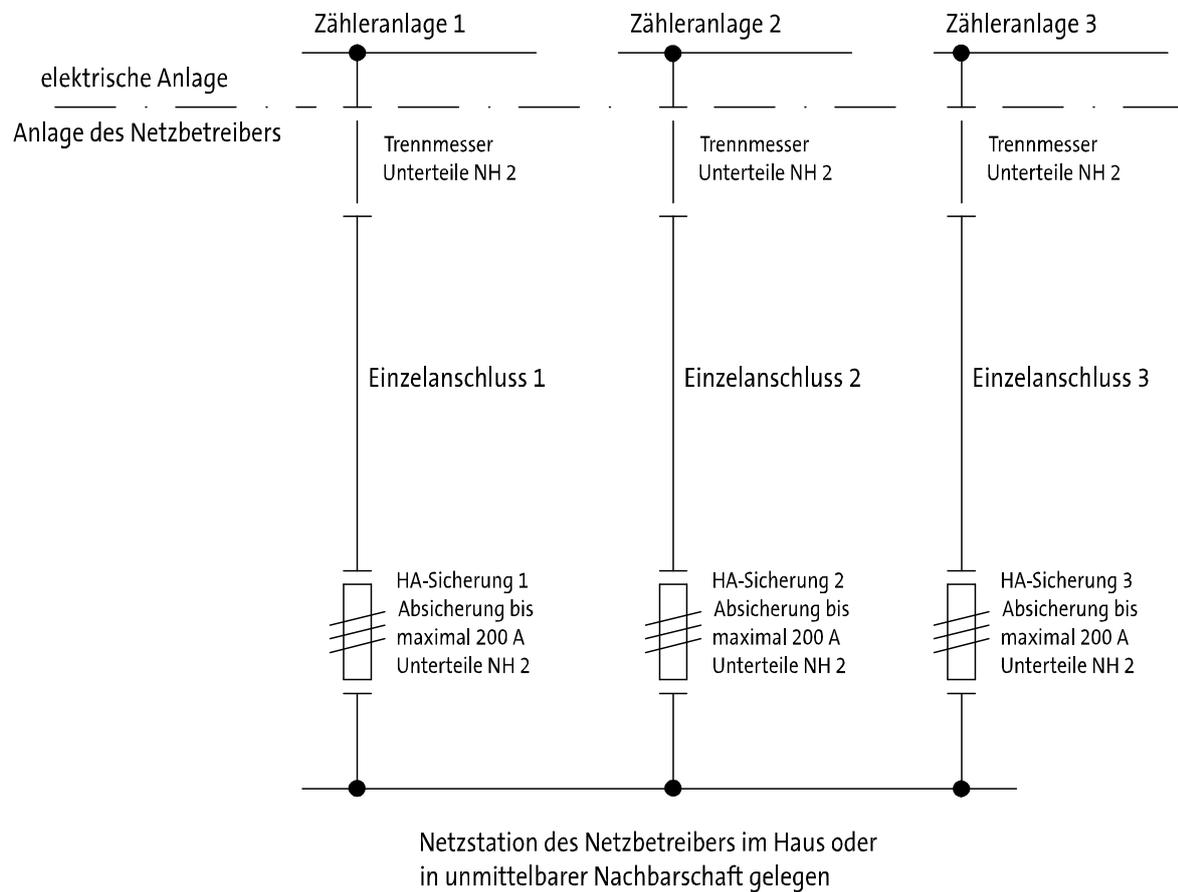
Abbildung 2: Netzanschluss größer 125 A in Form von mehreren Einzelanschlüssen
