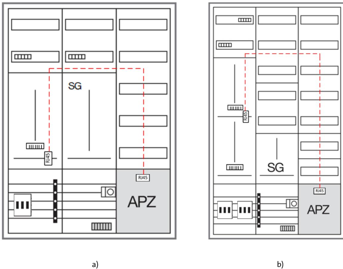
**Abbildung 4:** Beispiel für Zählerschrank mit Höhe
