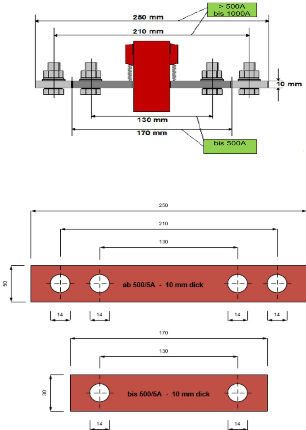
Abbildung 9: Maße der Wandlerschienen/-laschen für Stromwandler bis 1000 A.
